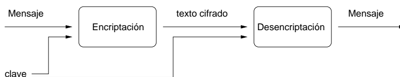
Figura 2.4: Criptografía de clave secreta. La misma clave se usa tanto para encriptación como para desencriptación.
